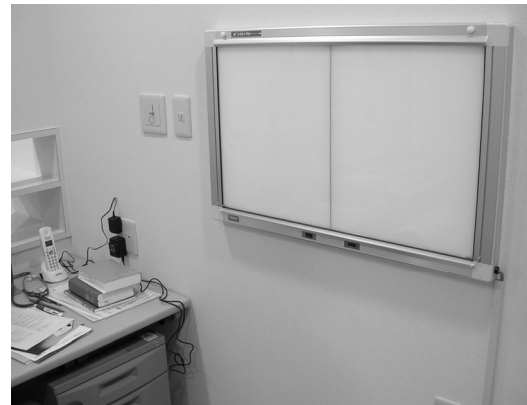
図 12.5-3 シャウカステンのサイズ 壁掛け型の一例
