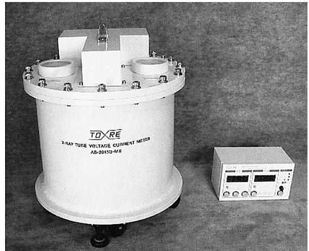
図 13.2-11 X 線管電圧管電流測定器表示部と分圧器 (管電流検出器内臓)
