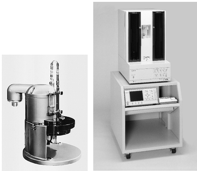
図 13.5-3 2π ガス・フロー・カウンタおよび放射能測定装置外観
