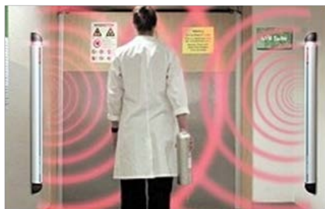
図 2 8) ポール型磁性体検知器
