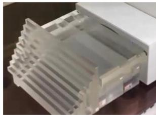
図 7 X 線骨密度測定装置用精度管理ファントム
