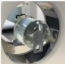
図 4 X 線 CT 装置付属の円柱形ファントム
