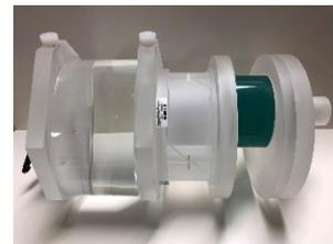
図 5 X 線 CT 装置付属の円柱形ファントム
