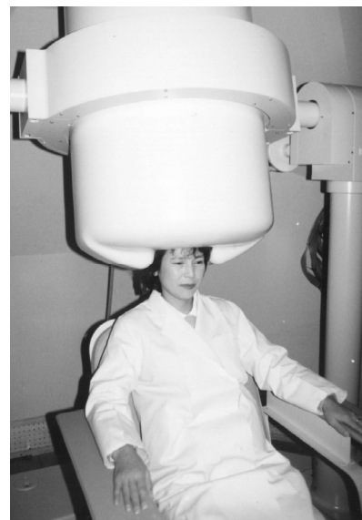
図 11.2-7 195チャンネル脳磁場計測装置の外観
