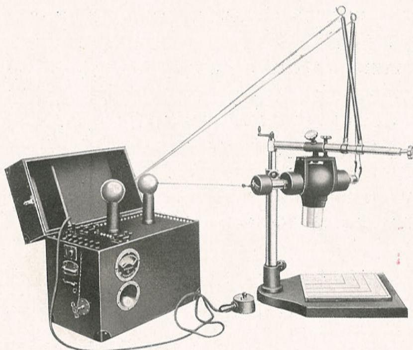
本装置は單相交流 100—350 ヴォルト、50—60 サイクルを電源とし整流機を用ひず最高60,50及40キロヴォルト三種の高壓電流を得 R型クーリッヂ管球を用ひ連續5 ミリアムペア、瞬間30 ミリアムペアを出し得るものにして装置全部を4 個の格納箱に納め二人にて運搬し隨時簡易に之を組立て透視診断は勿論撮影をなし得るものなり。
