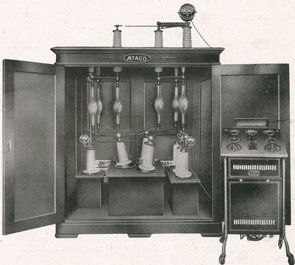
本装置は三相交流 220 ボルト、50—60 サイクルを電源とし 150 キロボルトに耐へ得るケノトロン 6 個を用ひ全整流をなし連續的定電圧を発生せしむるものにして従来の装置と其の趣を異にしコンデンサーを使用するものゝ如く湿氣に對する危険を考慮するの要なく且つ多大の電流を出し得るものなれば普通の撮影に際し陰影の對照頗る鮮明なるのみならず遠距離撮影及瞬間撮影に適し限界波長 0.08—0.24 オングストローム単位の範圍に於ける任意の高壓電流を得連續 30 ミリアムペア、瞬間 500 ミリアムペアを出し得べし。
