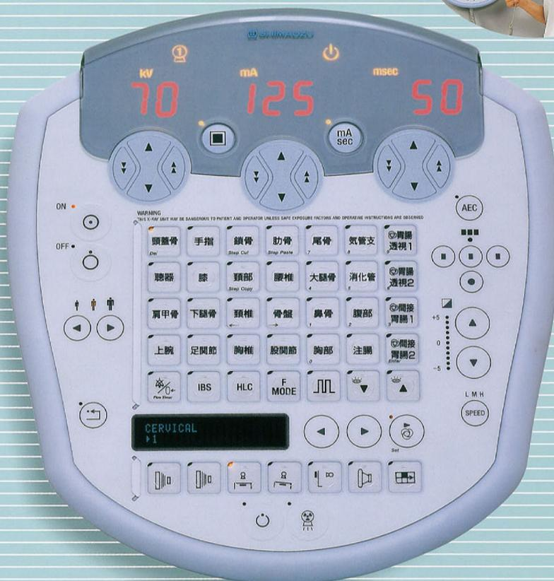
インバータ方式X線高電圧装置
